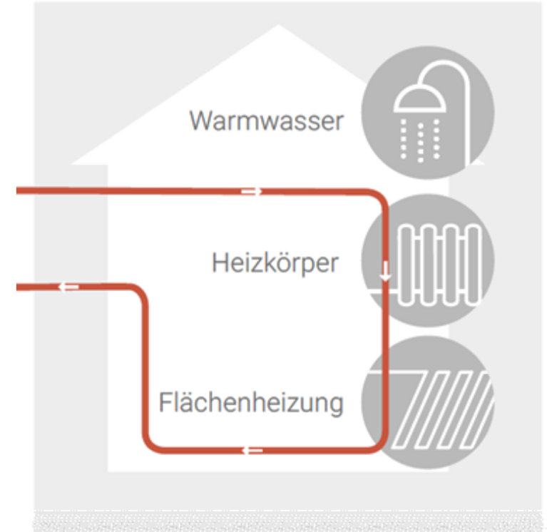
Wärmeverteil- und Speichersystem
